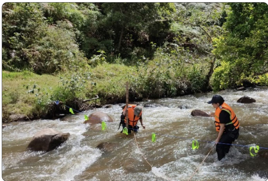
Figura Nro. 4.9: Aforo mediante método con flotadores
